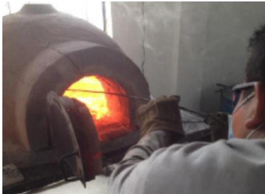
Figura 6. Medición de temperatura de enfriamiento
