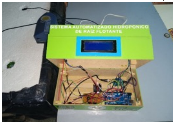
Figura 4. Circuito electrónico en interfaz de protección
