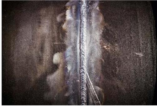
**Figura 6** soldadura adecuada
