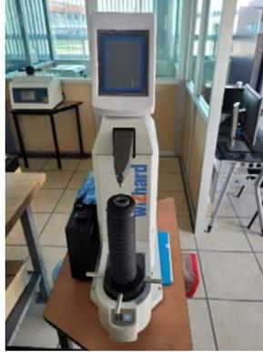
**Figura 4** Durómetro Mitutoyo WizHar
