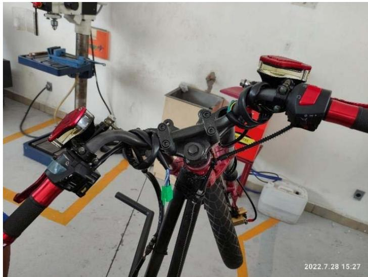
**Imagen 22** Mangueras sistema de frenado
