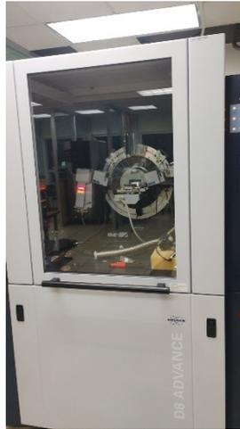
**Figura 10:** difractómetro de rayos x
