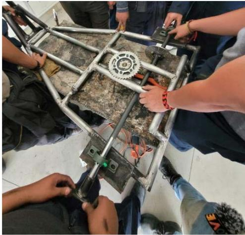
**Imagen 14** Ajustes para el eje trasero
