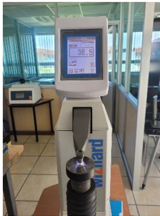
**Figura 13** Medición de dureza de la Muestra 1.
