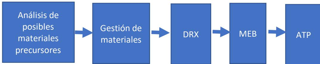
**Figura 1.** Proceso de síntesis y caracterización de cerámico.
