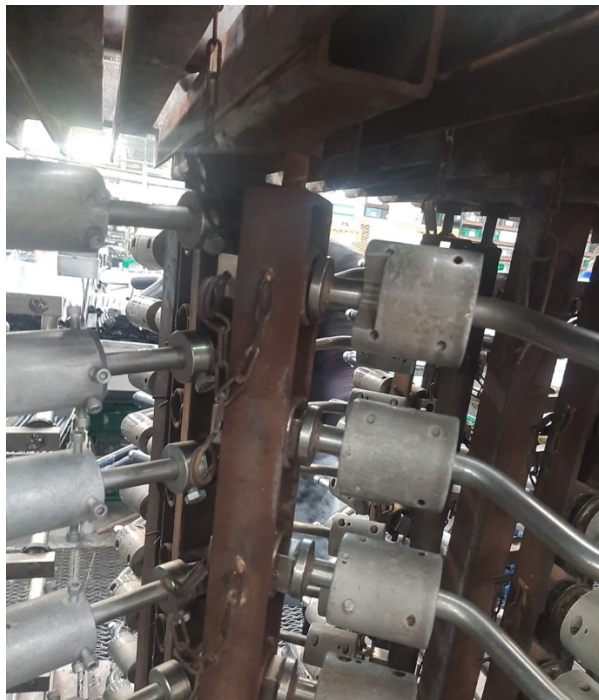
Figura 8. Colocación de seguros en base de mandriles
