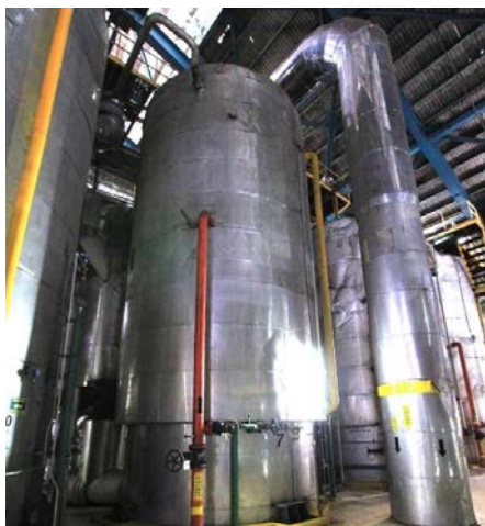
Ilustración 10 Evaporación de agua y concentración de jugo. (Fuente: GRUPO PIASA, 2018).
