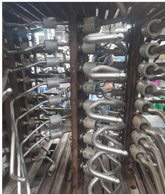
Figura 7. Montaje de mandriles en base tipo slide rack
