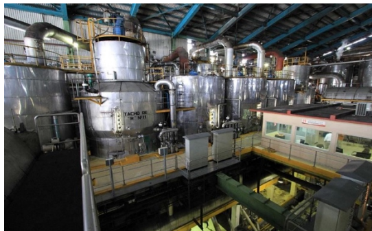
Ilustración 11 Cristalización de sacarosa. (Fuente: GRUPO PIASA, 2018).
