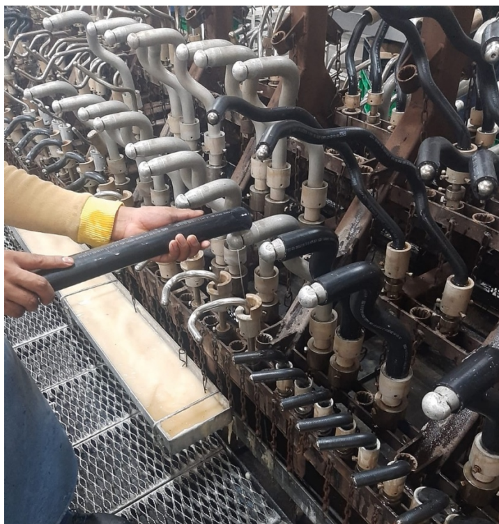
Figura 3. Aplicación de lubricante sobre mandriles
