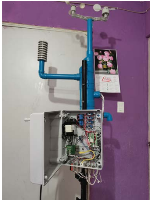
Figura 4. Dispositivo de medición de CO, diseñado en el Instituto Tecnológico de Boca del Río,.
