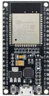
Figura 6 Módulo ESP32. Tomado de (Espressif Systems, 2021)
