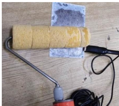
Figura 8. Detector de poros. [Fotografía como evidencia de la experimentación].
