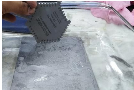
Figura 1. Medición de la película húmeda. [Fotografía como evidencia de la experimentación].
