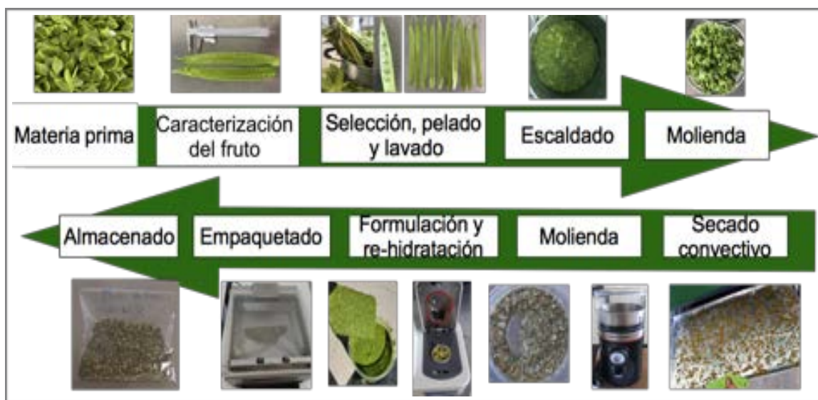
Figura 3. Proceso de secado convectivo del guaje y formulación de la salsa deshidratada.
