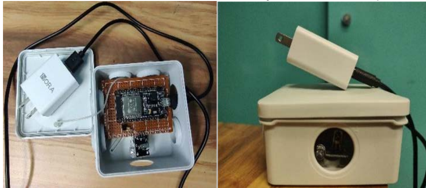
Figura 9 Prototipo de módulo infrarrojo construido
