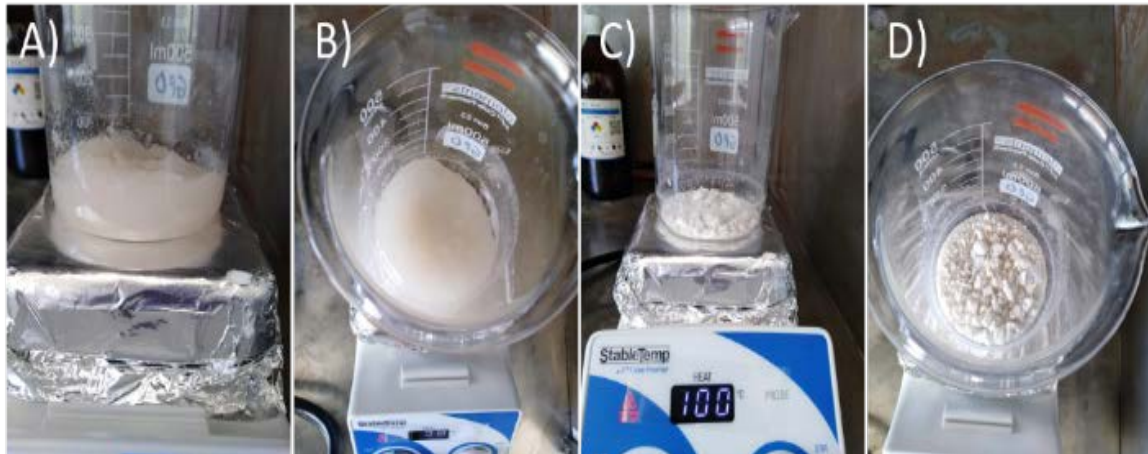
Figura 2. Síntesis de óxido de silicio ( \text{SiO}_2 ) por el método sol-gel (Bedolla & Muñoz, 2020). A y B corresponden a la formación del Gel, C y D corresponden al proceso de secado.
