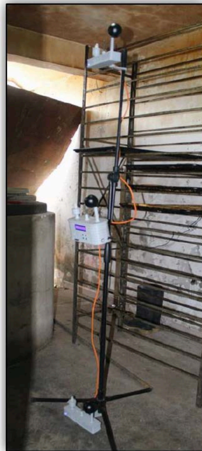
Figura 4. MET (Medidor de Estrés Térmico) evaluando espacio de trabajo con condiciones extremas elevadas. (Elaboración propia).
