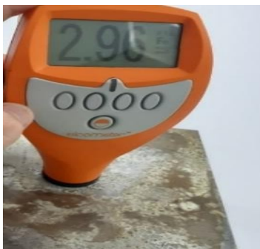
Figura 2. Medición de película seca. [Fotografía como evidencia de la experimentación]
