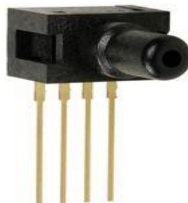
Figura 8 26PCBFA6G, sensor de presión, tomado de (Newark, 2021).
