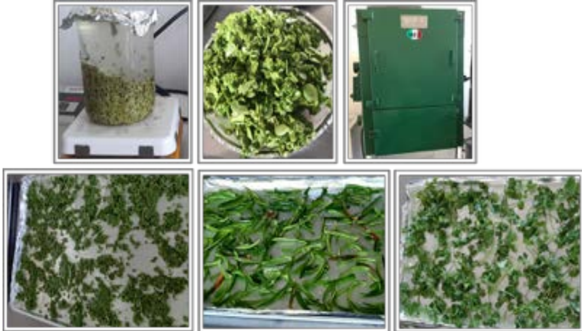
Figura 2. Experiencias en el secado convectivo de guaje, chile y cilantro. En orden de Izquierda a derecha y de arriba a abajo, se presenta el proceso de deshidratación osmótica de guaje, guaje molido, secador de charolas y disposición para el secado de guaje, chile y cilantro.
