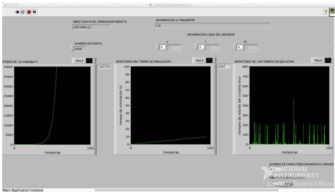
Figura 3. Simulación del sistema dinámico mediante el esquema de comunicación cliente-servidor. En la Figura 3, se puede constatar que se ha empleado la dirección IP y el número de puerto correcto para lograr que se establezca la comunicación por internet. De igual manera, se puede observar que el sistema emulado es un sistema inestable que dificultará el diseño de la estrategia de control. Además, los tiempos de retardo inherentes al enlace de comunicación han sido medidos para 2,000 instancias en la computadora servidor. Dichos tiempos tienen un comportamiento aleatorio (Valdez, 2014a), (Valdez, 2014b), (Guevara, 2002) y su variabilidad y comportamiento, se puede apreciar en la Figura 4.
