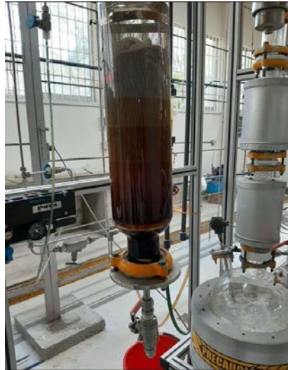
Figura 2. Extracción sólido Líquido del aceite de la borra de café
