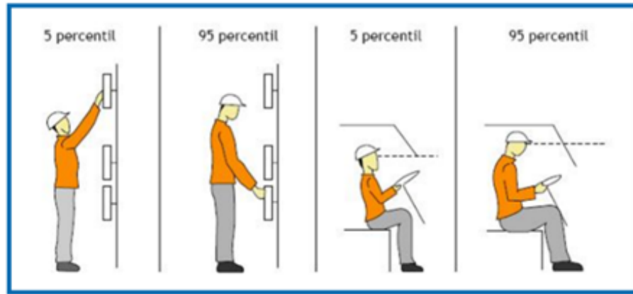
Figura 5. Ejemplos de diseño para personas de percentil 95 y percentil 5.
