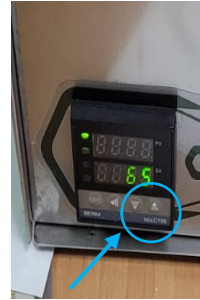
Figura 9 Señalización de control para ajuste de temperatura de Mufla
