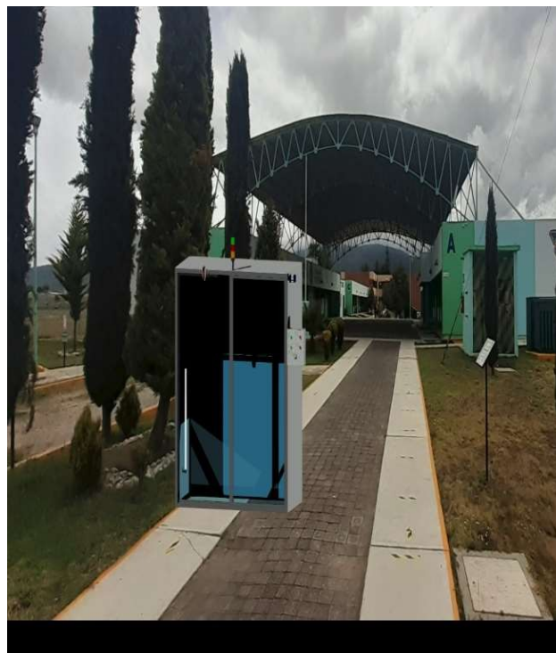
Fig. 7. Prototipo de cabina automatizada para desinfección de virus y bacterias, mediante el uso de luz UV-C
