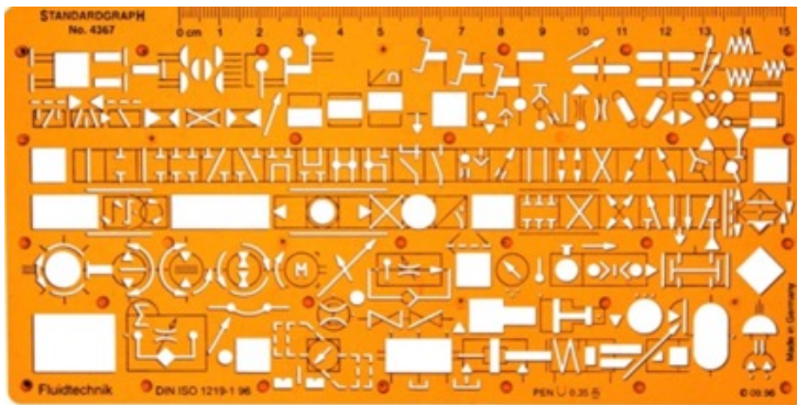
Figura 3. Platilla para símbolos neumáticos estandarizados
