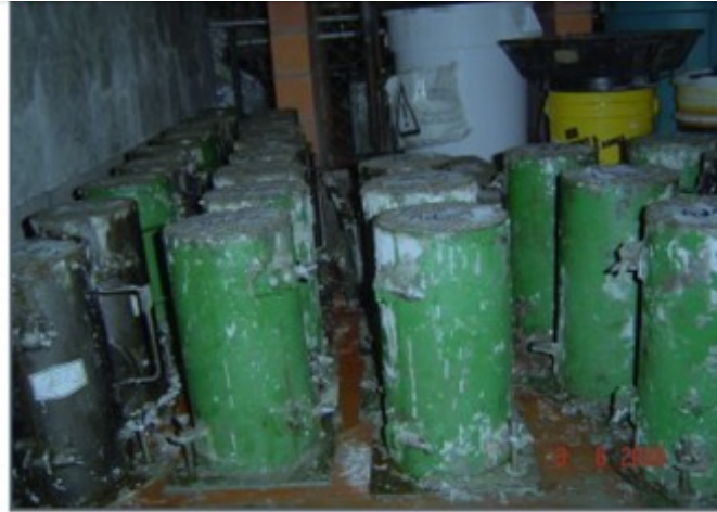
Figura 3.2 Colado de concreto en cilindros para prueba de resistencia a la compresión Elaboración propia
