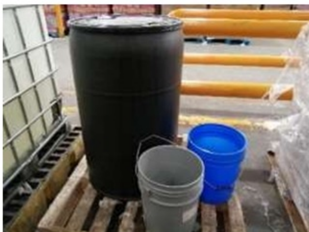
Figura 11: químicos sin etiquetado y fuera de la tarima de contención.
