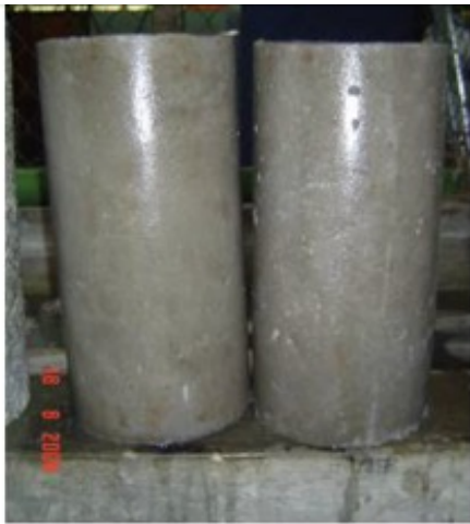
Figura 3.3 Cilindros fraguados recién extraídos del estanque Elaboración propia
