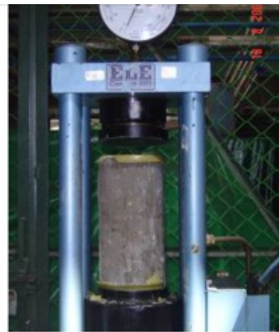
Figura 3.4 Testado de cilindros cabeceados con azufre, en prensa hidráulica Elaboración propia
