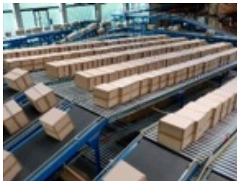
Figura 4.- vehículos de transporte de bandas y rodillos interno de un almacén
