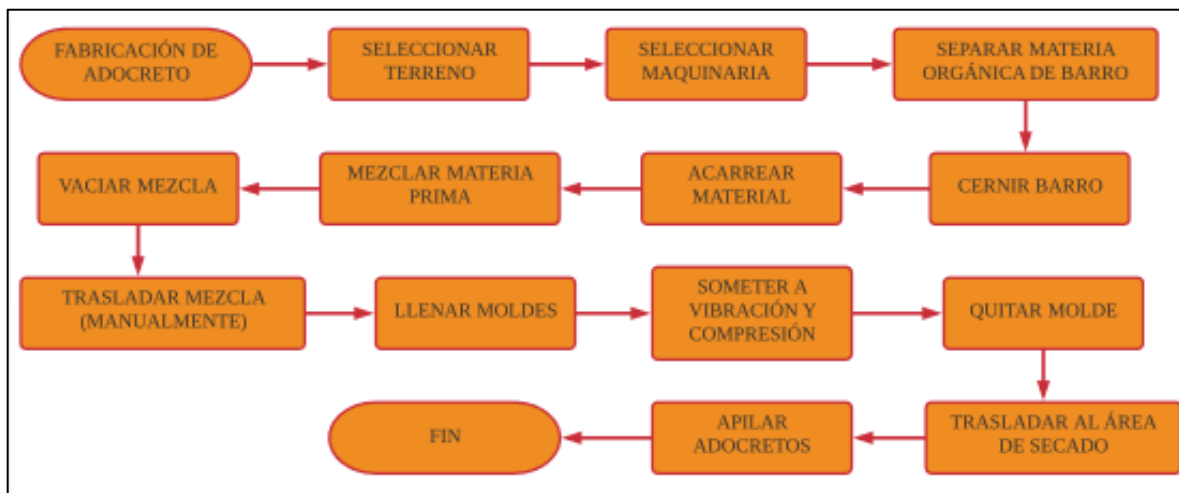
Figura 1. Diagrama de flujo de producción de adocreto
