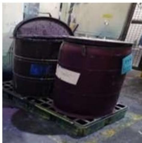
**Figura 12:** químicos con etiquetado y dentro de la tarima de contención.
