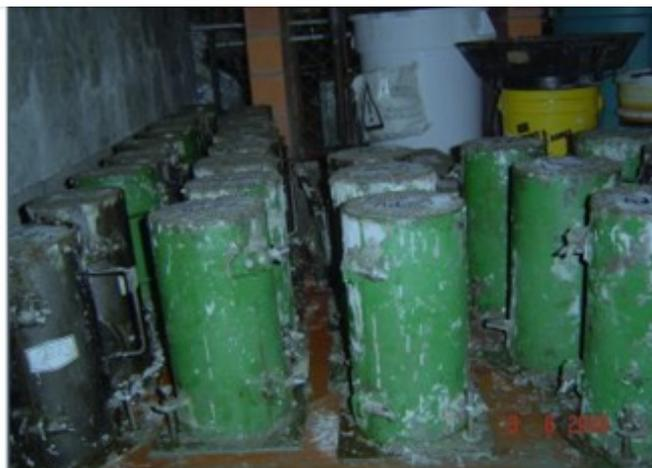
**Figura 3.2** Colado de concreto en cilindros para prueba de resistencia a la compresión
