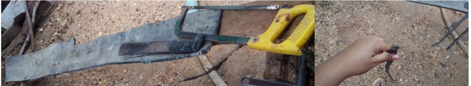
**Figura 2.1.** Cortes del neumático en sesiones.
