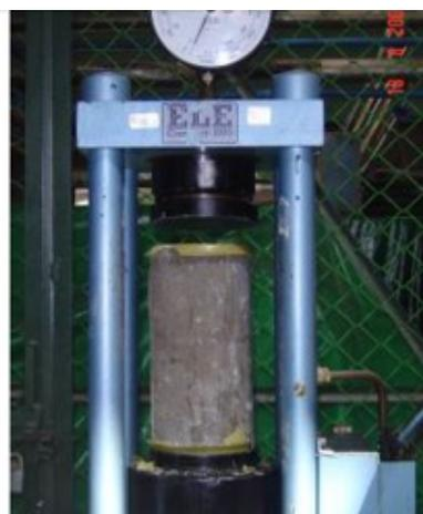
**Figura 3.4** Testado de cilindros cabeceados con azufre, en prensa hidráulica
