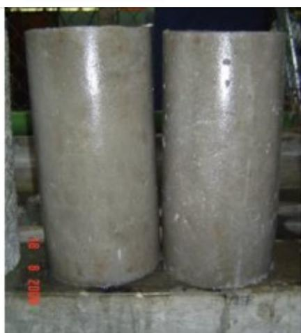
**Figura 3.3** Cilindros fraguados recién extraídos del estanque
