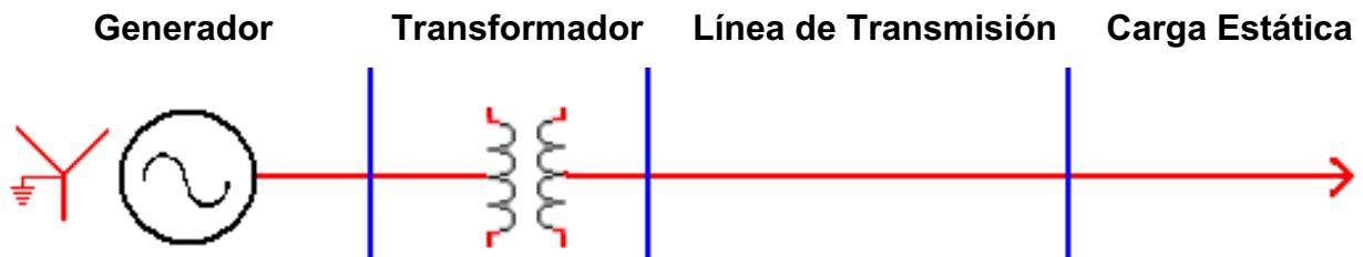
Figura 35 Diagrama unifilar representa al sistema de potencia
