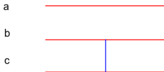
Figura 29 Falla de Línea a Línea
