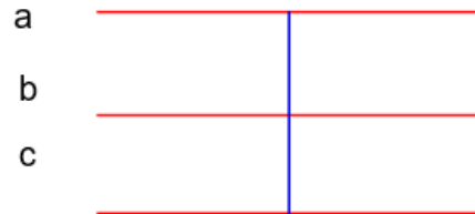
Figura 26 Falla trifásica simétrica
