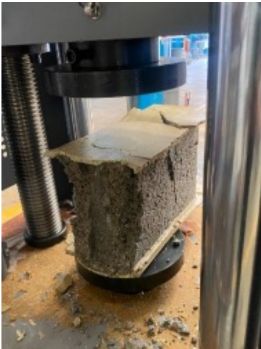
Figura 9. Falla del bloque posterior al ensayo de compresión individual ( f_p )
