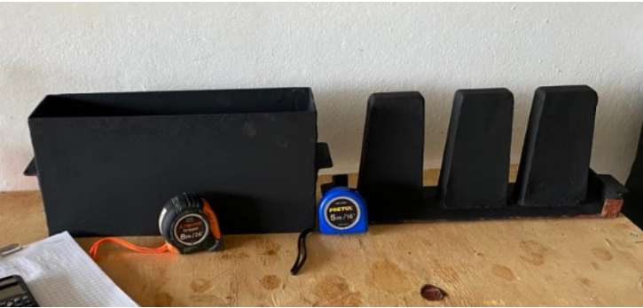
Figura 6. Equipamiento utilizado para el molde de bloques de concretos huecos durante el proceso experimental
