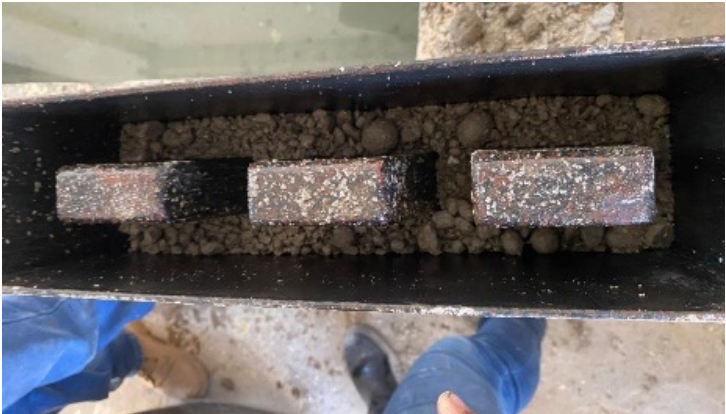
Figura 7. Colocación y compactación manual de la mezcla dentro del molde metálico
