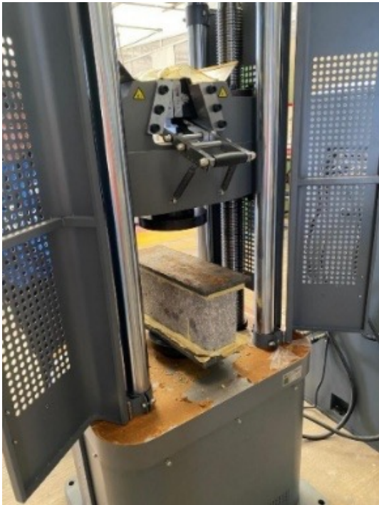
Figura 8. Ensaye de resistencia a la compresión individual ( f_p ) en bloque de concreto hueco
